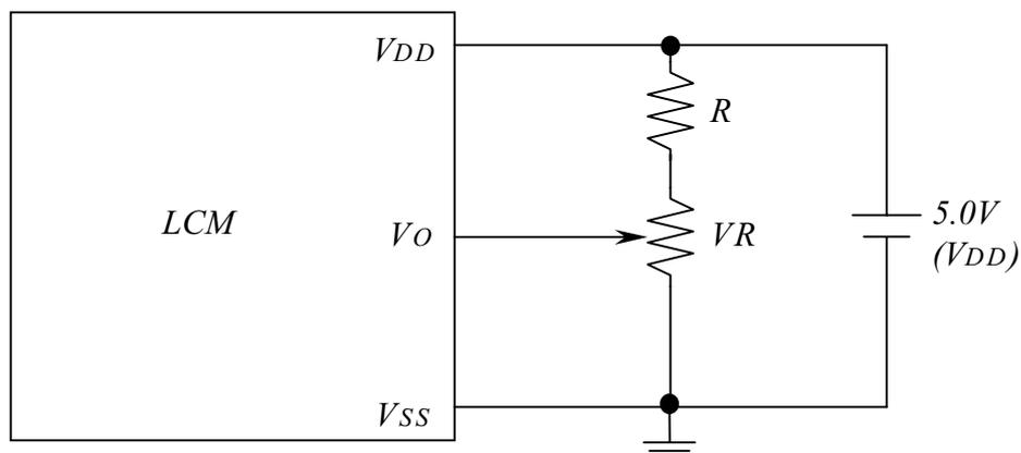
RECOMMENDED RESISTOR R:  $V_{DD} - V_O \geq 1.5V$
